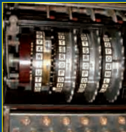
▲ Un particolare di Enigma, la macchina cifrante utilizzata dall'esercito tedesco nella Seconda Guerra Mondiale.
